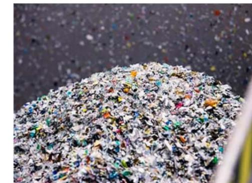
A través de diversos procesos de separación y limpieza, finalmente se crea regranulado a partir de estos residuos reciclados y procesados.
